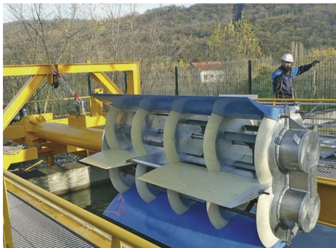
L'hydrolienne d'HydroQuest se caractérise par ses deux axes verticaux autour desquels gravitent trois couples de turbines.
