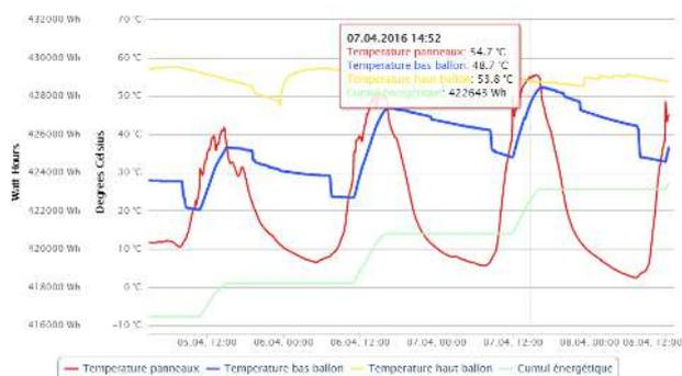
La T-Box permet une double supervision : par l'utilisateur et par les équipes Dualsun. Pour être assuré en permanence du bon fonctionnement thermique de l'installation, il suffit pour l'utilisateur de se connecter à son espace personnalisé DualSys. Il présente sous forme d'un graphique toutes les données de monitoring enregistrées qui sont ensuite conservées et sauvegardées en ligne.
